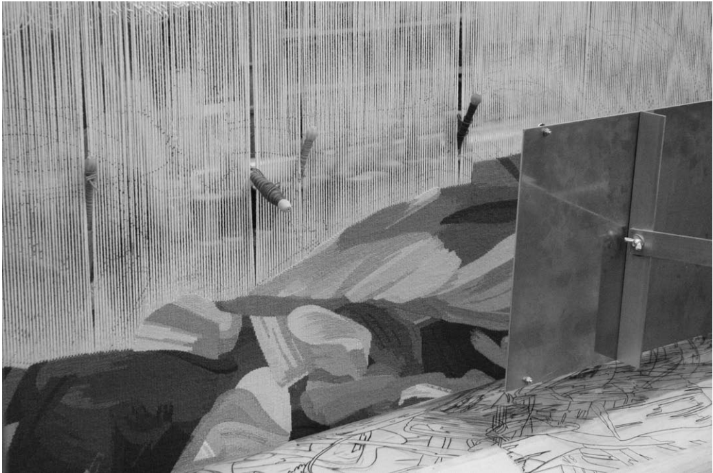
図1 現在のゴブラン製作所での豎機制作風景。緯糸を巻き付けた木針が何本か認められる。通常の織物とは異なり、緯糸が左右を貫通せず、部分ごとに色が入れられていくさまがわかる。織り手は経糸の後側から木針を通していき、制作の進行状態を前面に置かれた鏡によって確認する。下に見えるのがカルトンだが、その位置は当時とは異なる。筆者撮影。
